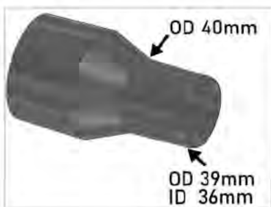
Adaptér pro výstupní otvor prachu - Rozměry hadicové přípojky
