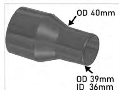
Støvtilslutningsadapter – Dimensioner på slangetilslutning
