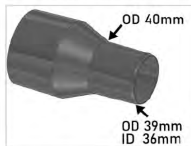
Adapter portu pyłu - wymiary złącza węża
