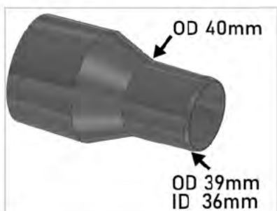
Adapter portu pyłu - wymiary złącza węża
