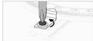
3. Desaperte o botão de bloqueio no esquadro combinado, faça deslizar a régua de modo a que a extremidade da régua fique nivelada com a face inferior da bigorna (E) e segure o esquadro combinado contra a lateral do trilho de guia.
