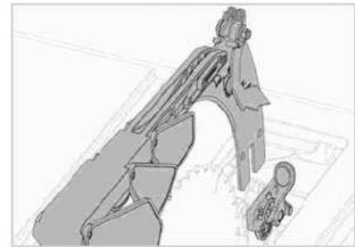
5. Encaixe os dois orifícios no spreader sobre os pinos de fixação (A).
