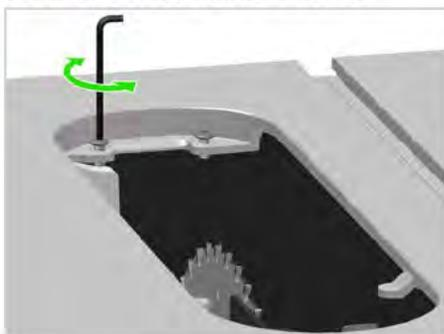
Se a inserção se tornar difícil de instalar ou remover, aumente o movimento vertical desapertando os parafusos (no sentido contrário ao dos ponteiros do relógio). Verifique reinstalando e retirando o encaixe várias vezes.
