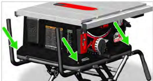
2. Utilize uma chave hexagonal de 5 mm e uma chave de 13 mm para retirar as ferragens dos quatro cantos da serra.
