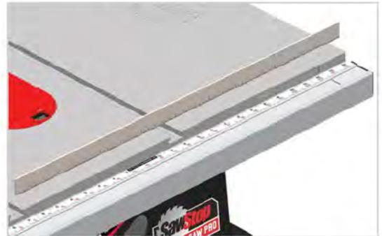
3. Verifique a folga entre a mesa extensível e a régua. Se houver uma folga, utilize um calibrador de folgas para determinar o tamanho. Se a folga for inferior a 0,05" (1,3 mm), a mesa extensível está alinhada, pelo que não é necessário qualquer ajuste. Se a folga for superior a 1,3 mm (0,05"), avance para o passo seguinte.
