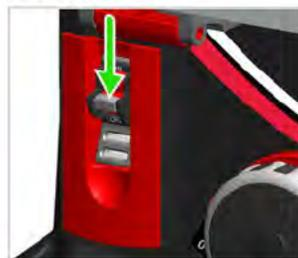
2. Introduza a chave hexagonal de 4 mm incluída no fecho de desbloqueio. Puxe a parte superior da chave hexagonal para a frente da serra para libertar o encaixe da mesa.
