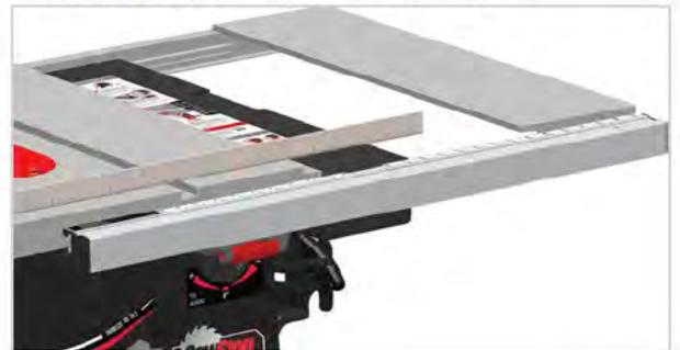
5. Utilize uma chave hexagonal de 4 mm para desapertar ligeiramente os dois parafusos entre o trilho frontal e a mesa extensível. Empurre para baixo ou puxe para cima a mesa extensível, conforme necessário, para corrigir o alinhamento.
