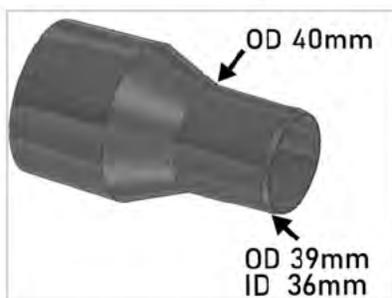
*Adaptador da saída de pó - Dimensões da conexão da mangueira*
