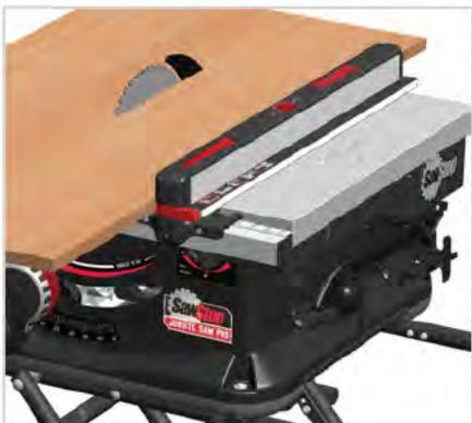
1. Utilize a linha indicadora vermelha no cursor do resguardo para determinar a largura de corte.
