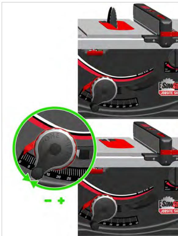
2. O ângulo de inclinação da lâmina é indicado pela posição do ponteiro vermelho sobre a escala de inclinação.
