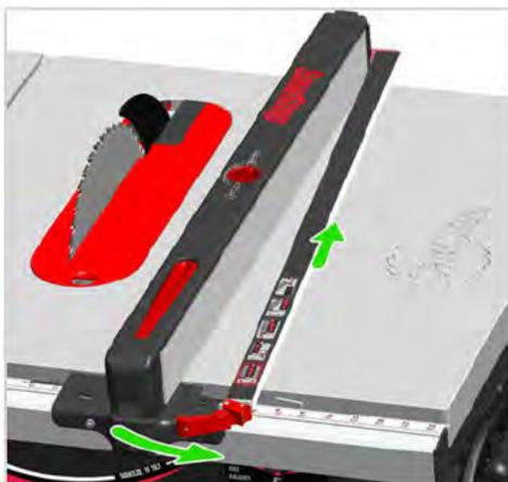
3. Vire a guia baixa e enganche a extremidade traseira no lado esquerdo da guia de corte (A). Empurre a alavanca para trás para bloquear a guia baixa no lugar (B).
