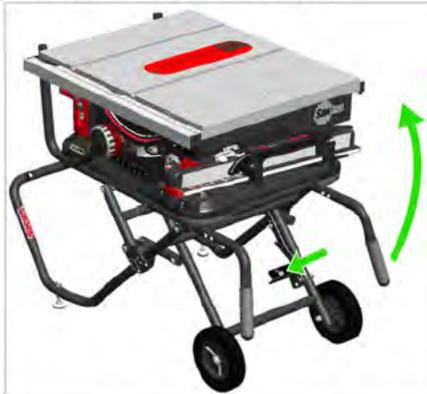
5. Levante as pegas até que o carro e a serra estejam completamente na vertical. Certifique-se de que a barra de bloqueio engata completamente na cavilha de bloqueio.
