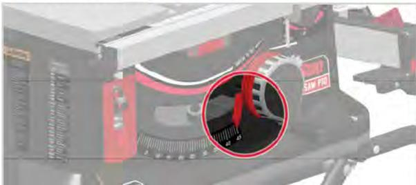
7. Ponha o motor a trabalhar e eleve lentamente a lâmina até à elevação máxima. Isto alargará a ranhura para cortes biselados até 45 graus.
