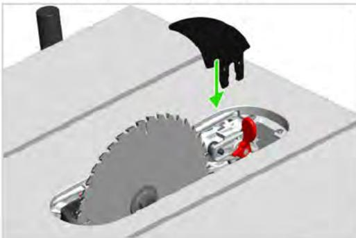
2. Rode a pega do grampo para baixo para fixar a lâmina separadora no lugar. Instale o encaixe da mesa.
