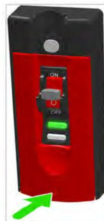
A luz verde de estado pisca rapidamente enquanto a lâmina gira para baixo. A serra sai automaticamente do modo de derivação depois de a lâmina parar. Depois de todos os cortes estarem concluídos, desligue a alimentação.
