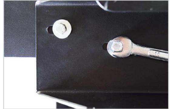
Ziehen Sie die Mutter aus Schritt 8 mit einem 13-mm-Schraubenschlüssel am Kopf der M8-Schraube und einem 13-mm-Schraubenschlüssel an ihrer Mutter fest, um die Halterung des Staubabsaugungsschutzes zusätzlich am Ausziehtisch zu befestigen.
