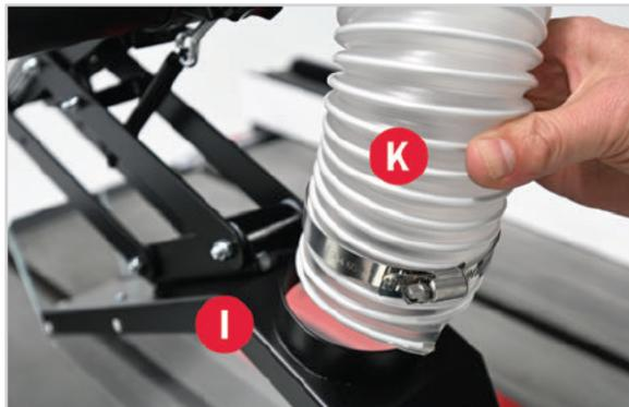
3. Ziehen Sie die beiliegenden Schlauchklemmen mit einem Schraubendreher fest, um den Staubschlauch und die in Schritt 1 und 2 beschriebenen Anschlüsse zu sichern.
