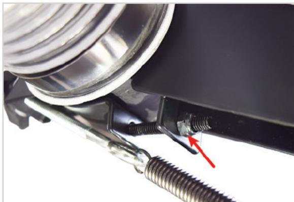
13. Lösen Sie den Feststellknopf der Über-Tisch-Schutzvorrichtung und heben und senken Sie die Schutzvorrichtung. Wenn Sie sie absenken, sollte sie wie zuvor flach auf der Tischplatte aufliegen. Wenn die Schutzvorrichtung nicht vollständig bündig mit dem Tisch abschließt, lösen Sie die Klemme des Tragarms, die Sie im vorherigen Schritt angezogen haben. Passen Sie den Tragarm zum Ausgleich ein wenig nach oben oder unten an.
