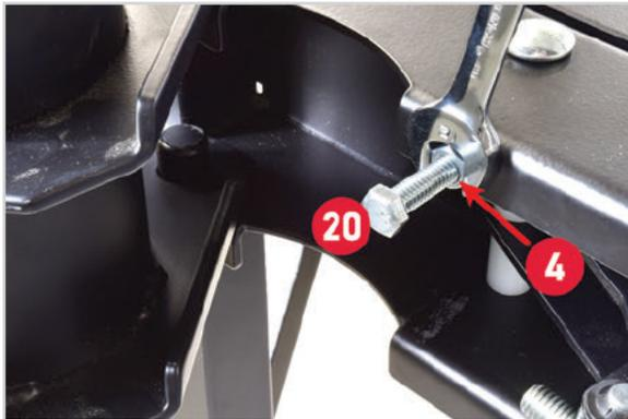
Stellen Sie die Mutter und die Schraube ein, um die Positionierung der Staubrohrbaugruppe so einzustellen, dass der Über-Tisch-Sägeblattschutz [1] mit (über) dem Sägeblatt ausgerichtet ist. Außerdem sollte der Schraubenkopf die Staubrohrbaugruppe berühren und als Anschlag dienen, wenn eine Ausrichtung erreicht ist, die eine optimale Staubabsaugung ermöglicht.
