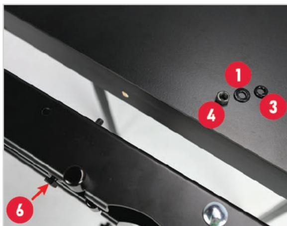
Führen Sie als Nächstes die Schraube [6] durch die obere Öffnung, an der die obere Strebe [A] mit der Halterung des Staubabsaugungsschutzes [B] verbunden ist, und durch das gebohrte Loch im Ausziehtisch, wobei die neu gebohrten Montageöffnungen des Ausziehtisches auf die Halterung des Staubabsaugungsschutzes ausgerichtet sind.
