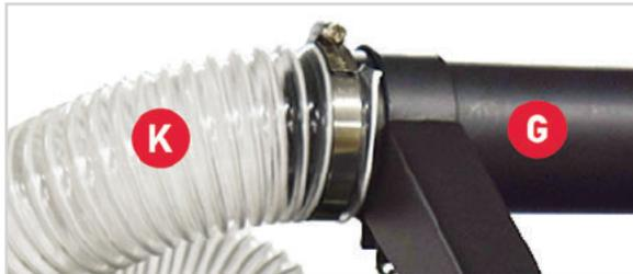
2. Schieben Sie das andere Ende des Staubabsaugungsschlauchs [K] auf den Über-Tisch-Sägeblattschutz [I] und stellen Sie dabei sicher, dass die Schlauchklemme etwa 1/4" bis 1/2" (6 bis 13 mm) über der Kante der 4" (102 mm) Öffnung des Über-Tisch-Sägeblattschutzes [I] liegt.
