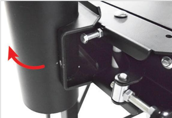
2. Lösen Sie die Mutter – M8 x 1,25 [10] mit einem 13-mm-Schlüssel und drehen Sie die Schraube – M8 x 1,25, 45 mm, Sechskantkopf [12] in Bezug auf die Halterung des Staubabsaugungsschutzes hinein oder heraus. Wenn sich die Schraube in der richtigen Position befindet, ziehen Sie die Mutter mit einem 13-mm-Schlüssel wieder an,
