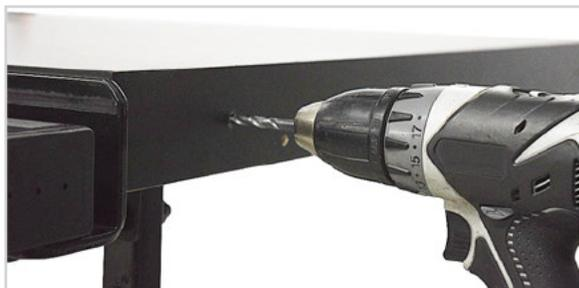
6. Bohren Sie mit einem 5/16"-Bohrer (8 mm) ein zusätzliches Loch an der Stelle, die Sie in Schritt 4 markiert haben.
