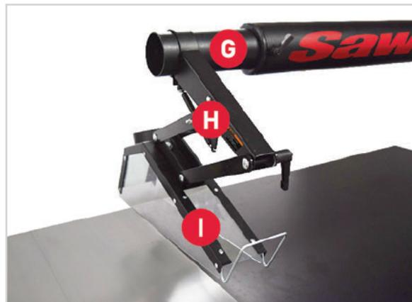
9. Lösen Sie den Feststellknopf des inneren Staubrohrs (unten rechts abgebildet) und fahren Sie das innere Staubrohr [G] aus oder ein, um den Über-Tisch-Sägeblattschutz [I] über dem Sägeblatt zu zentrieren. Ziehen Sie den Feststellknopf für das innere Staubrohr wieder an, um das innere Staubrohr und den Über-Tisch-Sägeblattschutz zu sichern.
