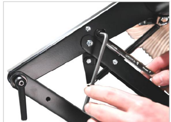
Entfernen Sie die Mutter nicht vollständig von der Anschlagschraube.
