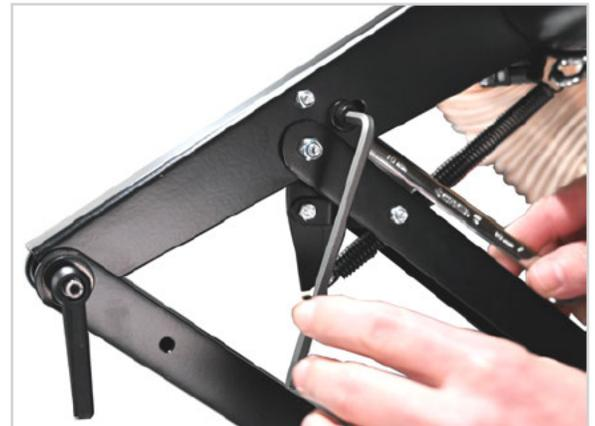
Ne retirez pas complètement l'écrou du boulon de butée.
