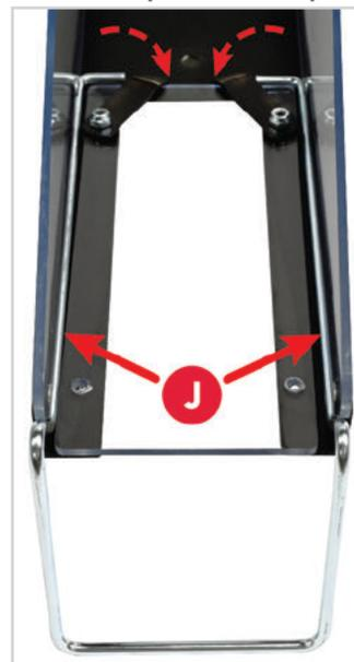
3. Remettez les languettes métalliques noires (x) dans leur position initiale, à la verticale, de manière à ce qu'elles recouvrent les extrémités de la poignée du protège-lame [J]. À l'aide d'une clé hexadécimale de 2,5 mm et d'une clé de 7 mm, resserrer les écrous supérieurs (x) que vous avez desserrés à l'étape 1.
