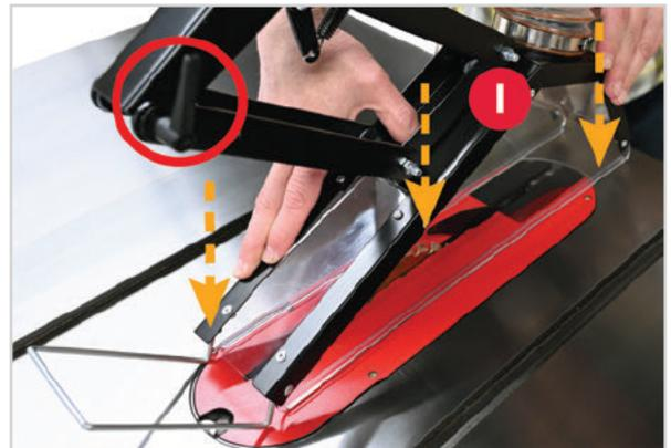
Resserrez la poignée de verrouillage de la protection flottante.
