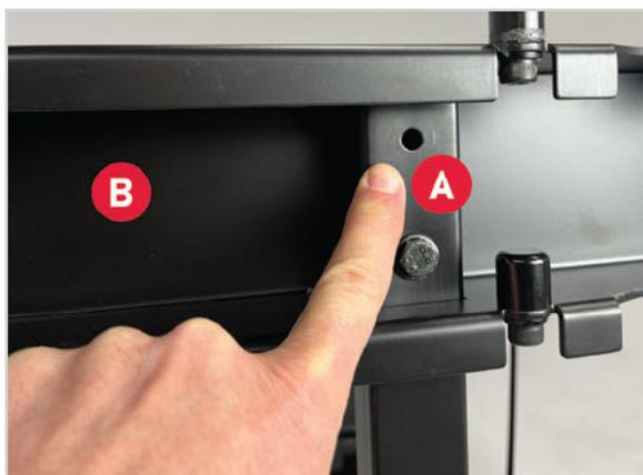
Ensuite, les trous de montage nouvellement percés de la table d'extension étant alignés avec l'ensemble du support de montage de l'accessoire de récupération de la poussière, insérez le boulon [6] à travers le trou supérieur où le pied supérieur [A] est relié au support de montage de l'accessoire de récupération de la poussière [B] et à travers le trou percé dans la table d'extension.
