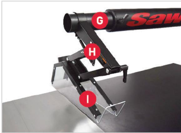
9. Desserrez le bouton de verrouillage du tube de poussière intérieur (illustré ci-dessous à droite) et déployez ou rétractez le tube de poussière intérieur [G] pour centrer le protège-lame flottant [I] sur la lame. Resserrez le bouton de verrouillage du tube de poussière intérieur pour fixer le tube de poussière intérieur et le protège-lame flottant.
