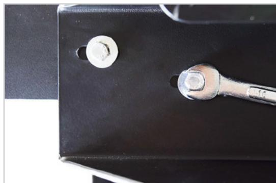
En utilisant une clé de 13 mm sur la tête du boulon M8 et une clé de 13 mm sur l'écrou que vous avez placé à l'étape 8, serrez l'écrou pour fixer davantage le support de montage de l'accessoire de récupération de la poussière à la table d'extension.
