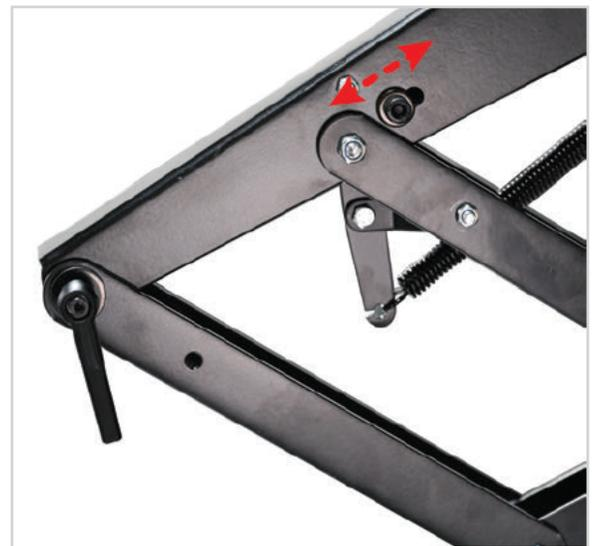
3. La protection ne doit jamais être réglée à plus de 5 mm au-dessus de la lame en position complètement relevée. Pour réduire la hauteur à laquelle la protection flottante peut être relevée, faites glisser le boulon de butée vers la gauche le long de la fente. Fixez le boulon à l'endroit souhaité à l'aide d'une clé hexadécimale de 5 mm et d'une clé à fourche de 10 mm.
