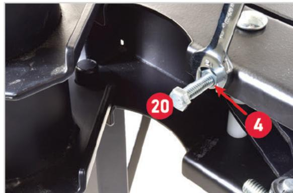
Ajustez l'écrou et le boulon pour régler le positionnement de l'ensemble du tube de poussière de manière à ce que le protège-lame flottant [I] s'aligne sur (au-dessus de) la lame. En outre, la tête du boulon doit entrer en contact avec l'assemblage du tube de poussière et servir de butée lorsque l'alignement permet d'obtenir une collecte optimale des poussières.
