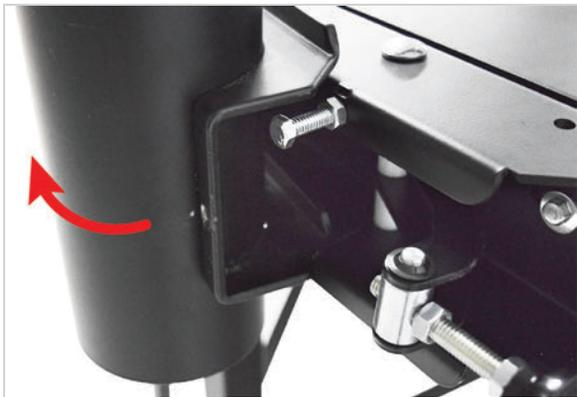
2. Desserrez l'écrou - M8 x 1,25 [10] à l'aide d'une clé de 13 mm et vissez le boulon - M8 x 1,25, 45 mm, tête hexagonale [12] vers l'intérieur ou l'extérieur par rapport au support de montage de l'accessoire de récupération de la poussière. Une fois que le boulon est dans la bonne position, utilisez une clé de 13 mm pour resserrer l'écrou afin de fixer le boulon.
