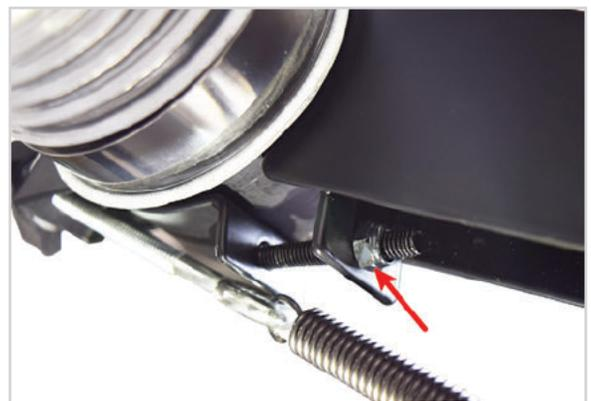
13. Desserrez la poignée de verrouillage de la protection flottante, puis relevez et abaissez la protection. Lorsqu'elle est abaissée, elle doit reposer à plat sur le plateau de la table, comme précédemment. Si le protecteur ne revient pas complètement affleurer la table, desserrez le collier de fixation du bras de support que vous avez serré à l'étape précédente. Ajustez le bras de support vers le haut ou vers le bas pour compenser.
