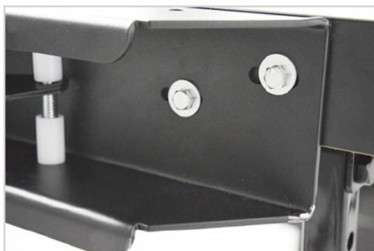
10. Confirmez que le support de montage de l'accessoire de récupération de la poussière est toujours correctement positionné contre l'extension. Si la position doit être ajustée, il faut utiliser l'espace libre offert par les fentes allongées.
