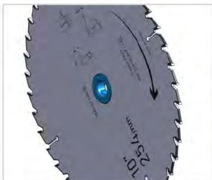
Assurez-vous que le sens de rotation de la lame correspond au sens des dents, comme indiqué par la flèche imprimée sur la lame.
