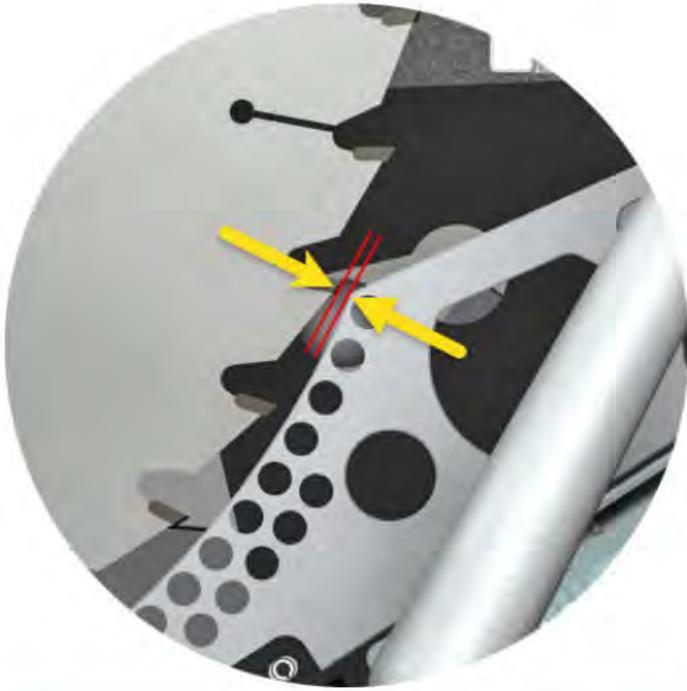
1. Pour accéder au boulon de positionnement du frein, réglez l'angle d'inclinaison sur 0° et réglez l'élévation de la lame à environ 1 1/2 pouces (38 mm) au-dessus du dessus de la table. Le boulon sera accessible par l'ouverture du dessus de la table. La tête du boulon est peinte en jaune pour une meilleure visibilité.
