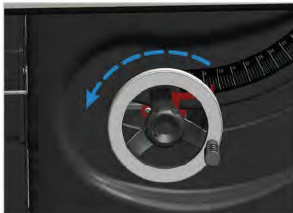
7. Réglez le biseau à 24,5° à l'aide du volant situé sur le côté droit de la scie. Cette étape permet de positionner le moteur de manière à optimiser le centre de gravité de la scie par rapport au centre de la table.
