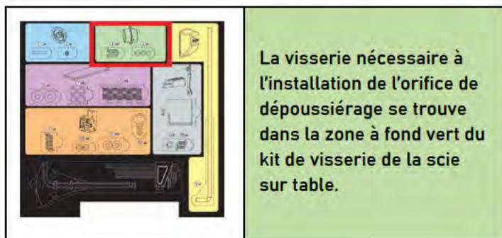
La visserie nécessaire à l'installation de l'orifice de dé poussiérage se trouve dans la zone à fond vert du kit de visserie de la scie sur table.
