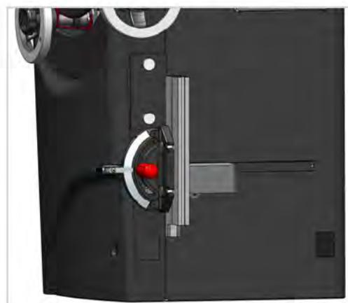
La barre principale de la jauge à onglets s'insère dans les fentes en forme de T de la table de la scie. Il y a une fente de chaque côté de la lame et la jauge à onglets peut être utilisée dans l'une ou l'autre fente. Cependant, n'utilisez pas la jauge à onglets dans la fente située à gauche de la lame lorsque vous effectuez des coupes en biseau.
