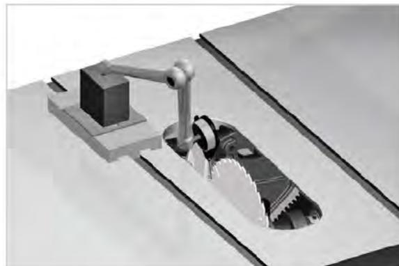
En fonction de la géométrie de votre indicateur à cadran, il peut être nécessaire de positionner l'indicateur en dessous de la table.
