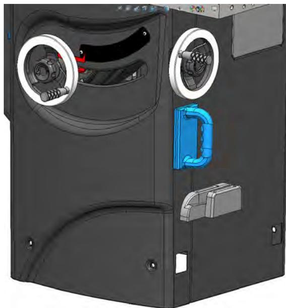
Cet accessoire doit être rangé vers ou sur l'avant de la scie, à un endroit où il est facilement accessible à l'utilisateur. Lorsque le bloc poussoir n'est pas utilisé, évitez de le ranger sur la partie supérieure de la table de sciage, où il pourrait gêner les opérations de coupe et entraîner des blessures graves.
