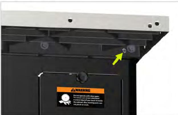
Si la mesure est positive, desserrer la vis de positionnement gauche et serrer la vis de positionnement droite. Si la mesure est négative, desserrez la vis de positionnement droite et serrez la vis de positionnement gauche. Veillez à desserrer la vis opposée avant de serrer une vis.
