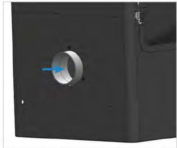
Bien que l'orifice de dépoussiérage situé à l'arrière de votre scie nécessite un tuyau flexible de 4 po (101 mm) de diamètre, l'utilisation d'adaptateurs et l'utilisation d'un tuyau ou d'un conduit de plus grand diamètre sur la plus grande longueur du parcours entre le collecteur de poussière et la scie permettront un dépoussiérage plus efficace.
