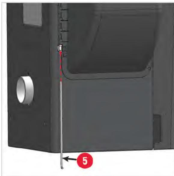
3. Tournez la tige du couvercle du moteur de manière à ce que l'extrémité courbée de la tige s'insère dans le crochet (C) du couvercle du moteur, juste en dessous du tube métallique inférieur.
