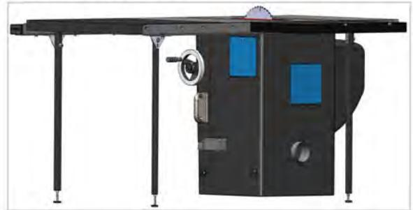
Une clé hexadécimale est nécessaire pour desserrer une fixation associée à chacun de ces points d'accès. Après avoir accédé à l'intérieur de la scie, veillez à utiliser la clé hexadécimale pour resserrer la vis de fixation afin de sécuriser l'ouverture.
