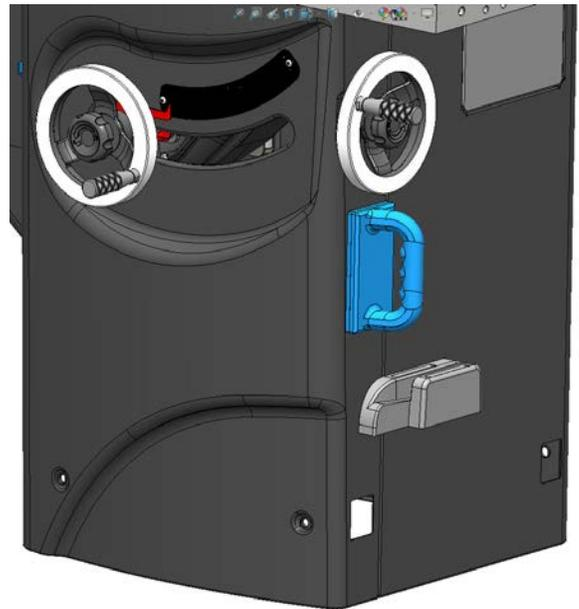
Dieses Zubehör sollte vorne an der Säge aufbewahrt werden, wo es für den Benutzer leicht zugänglich ist. Wenn der Schiebblock nicht in Gebrauch ist, bewahren Sie den Schiebblock nicht auf der Oberseite des Sägetisches auf, wo er den Sägevorgang stören und möglicherweise zu schweren Verletzungen führen könnte.
