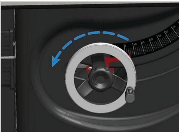
7. Stellen Sie die Gehrungseinstellung mit dem Verstellrad auf der rechten Seite der Säge auf 24,5° ein. Dieser Schritt positioniert den Motor so, dass der Schwerpunkt der Säge zur Tischmitte hin optimiert wird.
