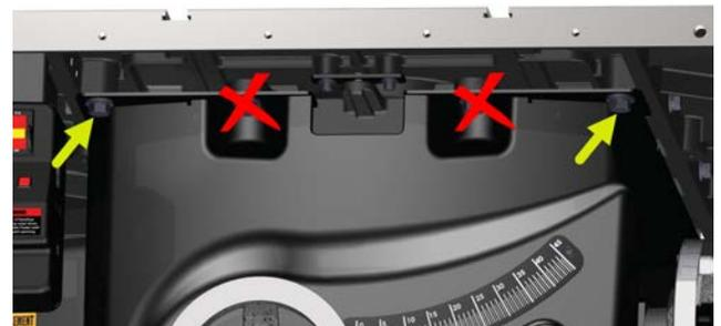
2. Nachdem Sie die oben beschriebenen vorderen und hinteren Schrauben gelöst haben, schieben Sie die Messuhr zur Vorderseite des Sägeblatts und stellen Sie die Anzeige auf Null. Schieben Sie die Messuhrhalterung zur Rückseite des Sägeblatts. Die Messuhr sollte jetzt einen Wert nahe dem zuvor ermittelten Durchschnittswert anzeigen. Beachten Sie die Richtung der Messuhr-Anzeige, ob sie positiv oder negativ ist.
