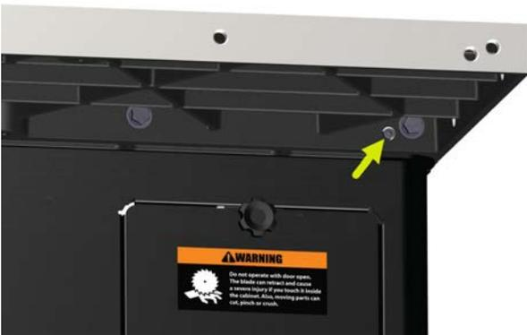
Wenn der Messwert positiv ist, lösen Sie die linke Positionierschraube und ziehen Sie die rechte Positionierschraube fest. Wenn der Messwert negativ ist, lösen Sie die rechte Positionierschraube und ziehen Sie die linke Positionierschraube fest. Stellen Sie sicher, dass Sie vor dem Festziehen einer Schraube die gegenüberliegende Schraube lösen.
