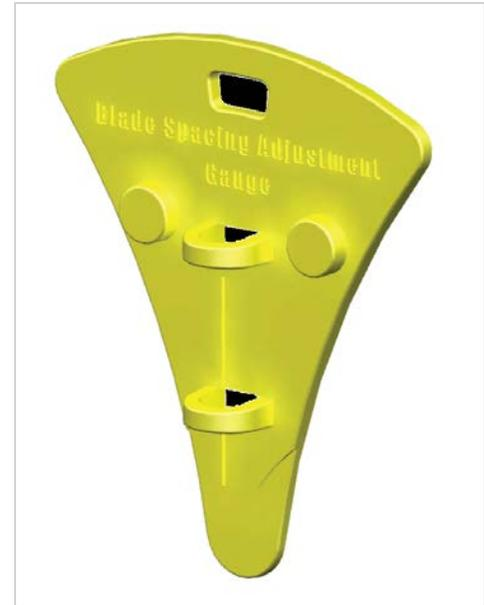
Die beiden Schlitze an der Blattabstand-Einstellehre dienen zur Aufbewahrung des 8-mm-Sechskantschlüssels, der zur Einstellung der Bremsposition verwendet wird (wie in Schritt 2 beschrieben). Die Blattabstand-Einstellehre enthält außerdem Magnete, sodass sie an der Seite des Gehäuses der Professional Cabinet Saw befestigt werden kann.
