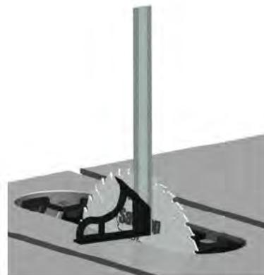
6. La altura máxima de la hoja por encima de la mesa debe ser de 3 1/8" (79,3 mm). Si la hoja está 33/16" (80,5 mm) o más por encima de la mesa, el tope superior de elevación se debe ajustar a menor altura. Si la hoja está a menos de 3 1/8" (79,3 mm) por encima de la mesa, puede ajustar el tope a mayor altura hasta 3 1/8" (79,3 mm). También puede ajustar el tope para que la altura máxima de la hoja sea inferior a 3 1/8" (79,3 mm).
