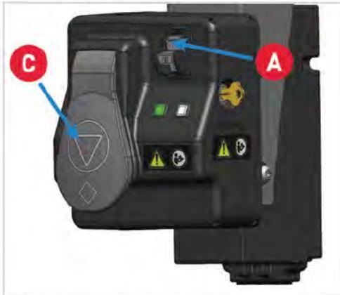
La palanca está diseñada de manera que el operador pueda presionarla con el muslo o la rodilla en caso de emergencia.
