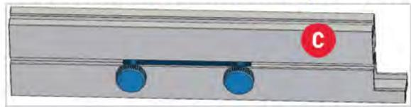
3. Coloque el calibre de inglete en la ranura de inglete situada a la izquierda de la hoja.
