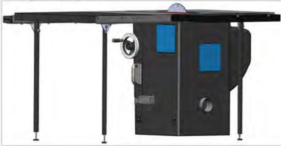
Se necesita una llave hexagonal para aflojar un tornillo de retención asociado a cada uno de estos puntos de acceso. Después de acceder al interior de la sierra, asegúrese de utilizar la llave hexagonal para volver a apretar el tornillo de retención con el fin de asegurar la abertura.
