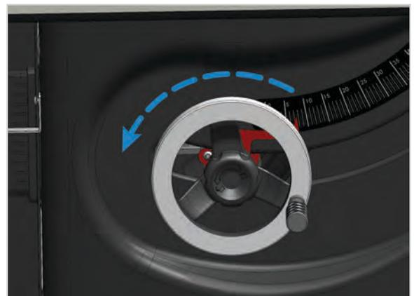
7. Ajuste el bisel a  $24,5^\circ$  con el volante situado en el lado derecho de la sierra. Este paso coloca el motor para optimizar el centro de gravedad de la sierra con respecto al centro de la mesa.
