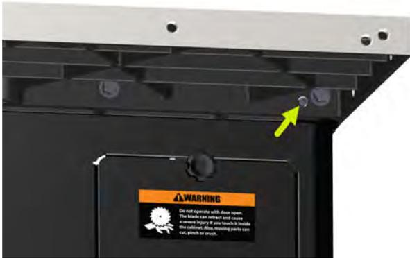
Si la medición es positiva, afloje el tornillo de posicionamiento izquierdo y apriete el tornillo de posicionamiento derecho. Si la medida es negativa, afloje el tornillo de posicionamiento derecho y apriete el tornillo de posicionamiento izquierdo. Antes de apretar un tornillo, asegúrese de aflojar el tornillo opuesto.
