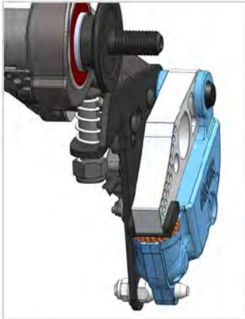
3. Inserte la llave del cartucho en el orificio de la carcasa del cartucho. El eje de la llave tiene un resalte que debe alinearse con un canal en el orificio. Como resultado, la llave solo se puede insertar en el orificio cuando la manija roja apunta hacia el trinquete de freno.
