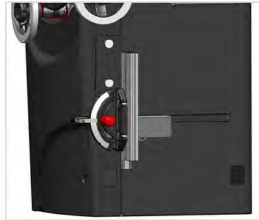
La guía principal del calibre de inglete encaja en las ranuras en forma de T de la mesa de la sierra. Hay una ranura a cada lado de la hoja y el calibre de inglete se puede utilizar en cualquiera de ellas. Sin embargo, no utilice el calibre de inglete en la ranura situada a la izquierda de la hoja cuando realice cortes en bisel.
