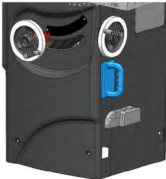
Este accesorio debe guardarse hacia o en la parte delantera de la sierra, donde sea fácilmente accesible para el usuario. Cuando no se utilice el bloque de empuje, no lo guarde en la parte superior de la mesa de la sierra, donde podría interferir con las operaciones de corte y provocar lesiones graves.
