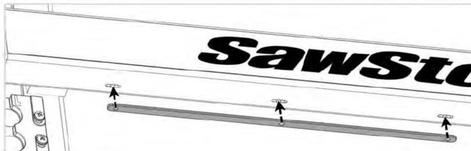
6. Remontez l'un des leviers de verrouillage avec son boulon et son ressort. Insérez cet assemblage dans l'un des trous du côté gauche du guide, puis vissez le boulon dans le trou de la barre de verrouillage.
