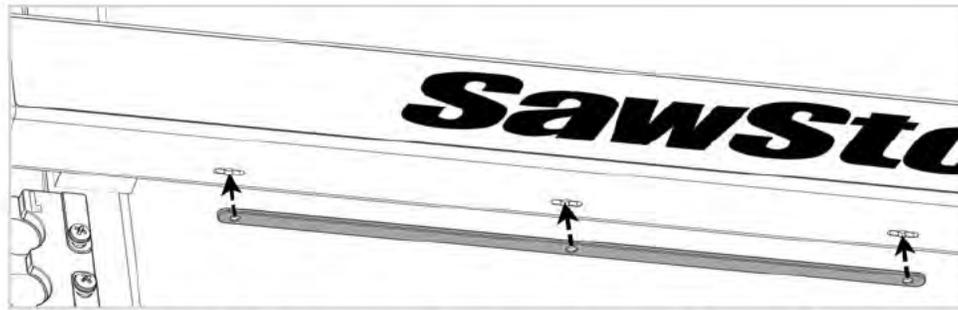
6. Vuelva a montar una de las palancas de bloqueo con su respectivo perno y muelle. Inserte este conjunto en uno de los orificios del lado izquierdo de la guía de corte y enrosque el perno en el orificio de la barra de bloqueo.
